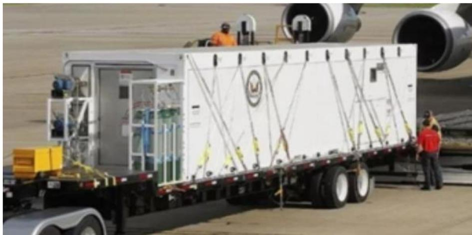
图 1-2 集装箱式生物隔离系统（CBCS）
